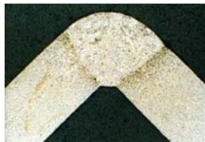
Bild 13. Mit einem Hochleistungs-Diodenlaser ohne Zusatzwerkstoff hergestellte Schweißnaht an einen Stahlgehäuse. (Foto: Fraunhofer-IWS)
