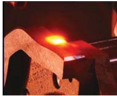
Bild 12. Härten einer Greiferkurve mit einem Hochleistungs-Diodenlaser. (Foto: Fraunhofer-IWS)
